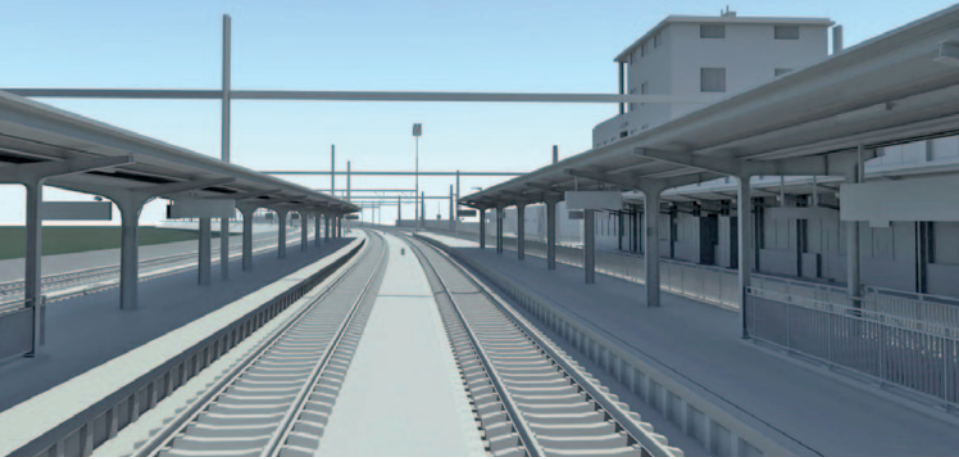
Jednoduchá vizualizace vytvořená v SW Synchro (pro stupeň PDPS – projektová dokumentace pro provádění stavby). Dole vizualizace nového zastřešení v SW Synchro (pro stupeň DSPS – dokumentace skutečného provedení stavby).
