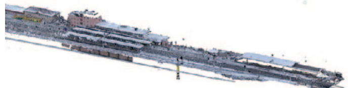
Proložení modelu DSPS celé stavby (dokumentace skutečného provedení stavby) mračnem bodů (výstup z laserového skenování).
